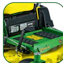
Plateforme rabattable : le repose pied peut se rabattre et permet un accès aisé au carter de coupe.
