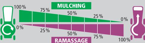
Pour s'adapter facilement à toutes les conditions, et pour bénéficier des avantages du mulching même lorsque l'herbe est trop haute ou humide, il est possible de choisir une position intermédiaire. Ainsi, une partie de l'herbe sera ramassée afin de garantir un résultat impeccable, tout en gagnant du temps puisque la quantité d'herbe ramassée, sera réduite.
